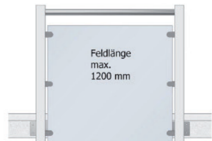
Modell 4005 (neu), mit Verlängerung d. Glaseinsatzes Glashalter als Punkthalter, (nur möglich mit matter Folie)
